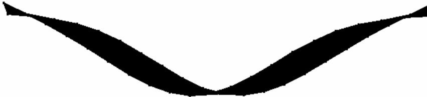
d) probíhá vybočení prutu
